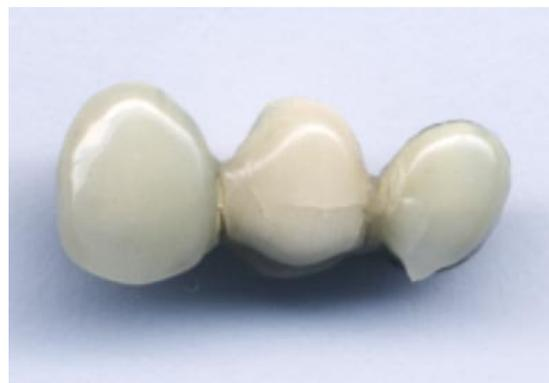
*Figura 6: Traiecte fisurale datorate suprasinterizării*
