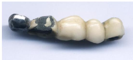
*Figura 3: Fractură adezivă prin jonțiunea metalo-ceramică*
