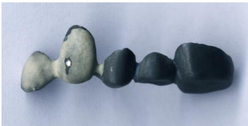
Figura 4.: Defect de turnare evidențiat macroscopic după sinterizarea stratului de masă ceramică opacă
