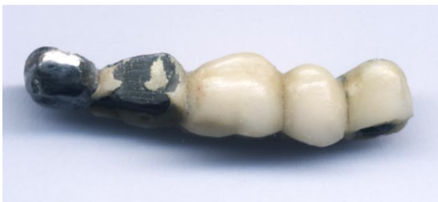
Figura 5.: Fractură adezivă prin joncțiunea metalo-ceramică probabil datorată unei tehnici de sablare incorecte
