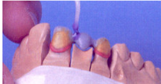
Figura 9. Modelarea machetei prin picurare
