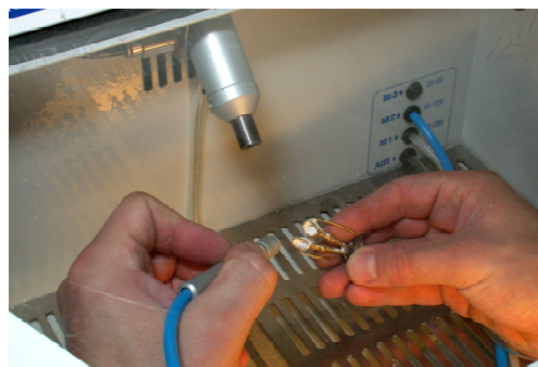
Figura 21. Sablarea cu corindon 250\mu\text{m}
