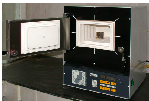
Figura 16. Cuptor de preîncălzire și încălzire a ambalajului
